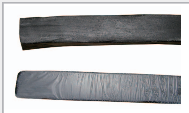
Vergelijking zwelband met en zonder schutfolie
